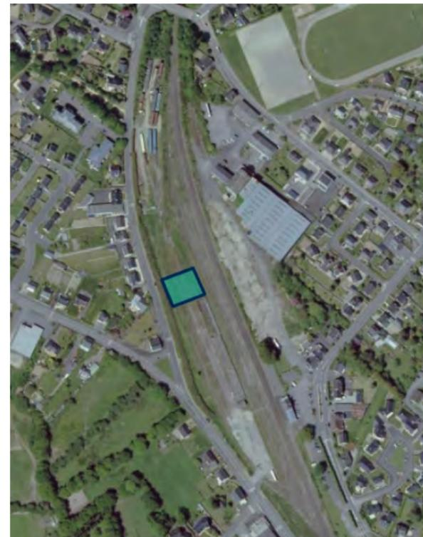
Visualisation de la superficie approximativement nécessaire à l'implantation d'une chaufferie biomasse sur le site
